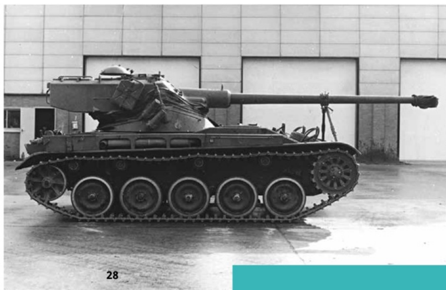
Rechter zijaanzicht van dezelfde tank. Op de torenbasis is een vlammen embleem van een granaat te zien met een cijfer. In de vijftiger- en zestiger jaren werd hiermee in vier gewichtscategorieën (1 t/m 4) aangegeven hoe de spoorwagens van de Franse spoorwegen (SNCF) met militair materieel geladen moesten worden.
