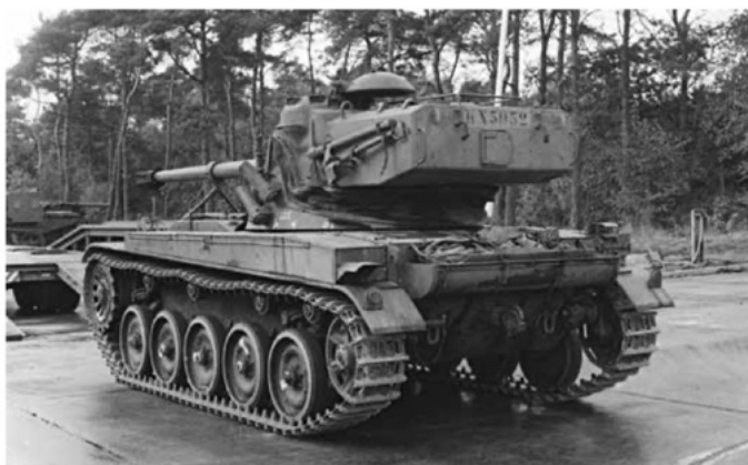
Linker achteraanzicht van een zojuist in Nederland afgeleverde AMX-13 lichte tank voorzien van een 75 mm kanon en stalen rupsbanden zonder rubber pads (september 1960).
